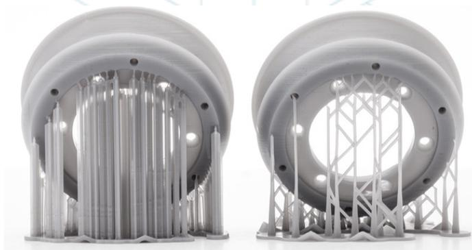
Figura 3 Strutture di supporto [12]
