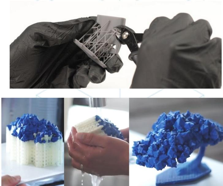
Figura 8 Rimozione attraverso immersione di materiale solubile [17] [18]
