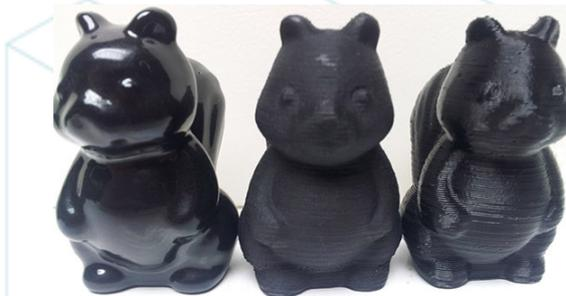
Figura 9 Tipologie differenti di finitura [19]
