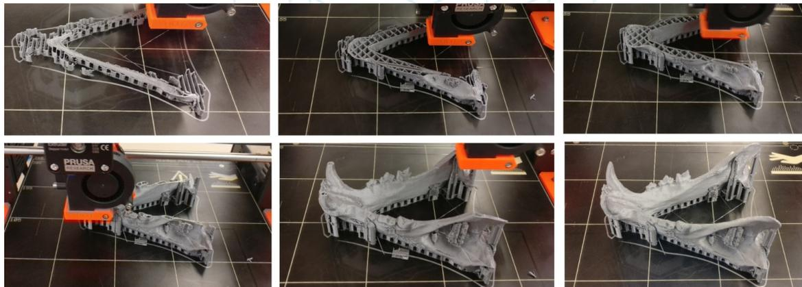
*Figura 17 Sequenza delle fasi di stampa della mascella [33]*
