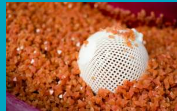
Figura 8: Pieza de SLS en el proceso de pulido por abrasión. [4]
