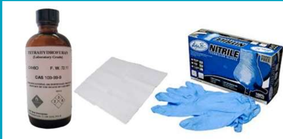
Figura 6: Materiales para el pulido del PLA [3]
