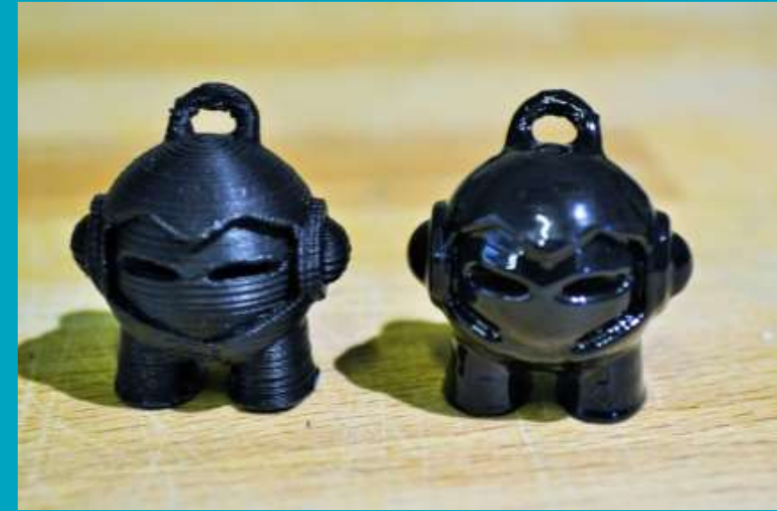
Figura 5: Ejemplo de pieza alisada con vapor de acetona
