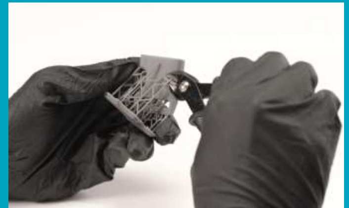
Figura 10: Eliminación de apoyos con pinza de cizallamiento. [5]
