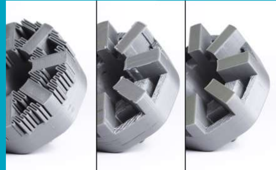
Figura 2: Una pieza impresa en 3D a lo largo de su postprocesado. [2]
