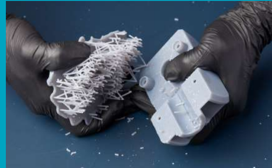
Figura 3: Ejemplo de retirada manual de un apoyo impreso. [1]
