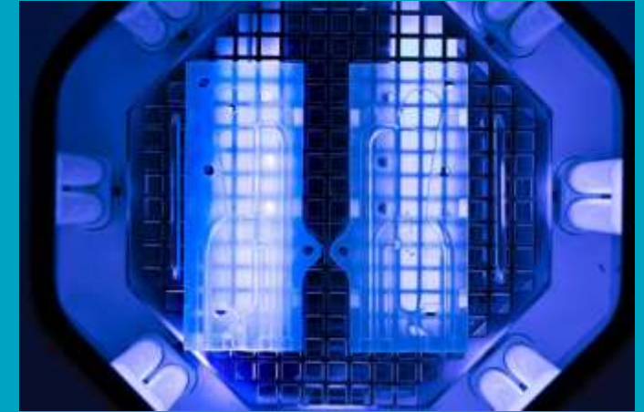
Figura 9: Piezas postcuradas con luz UV [5]
