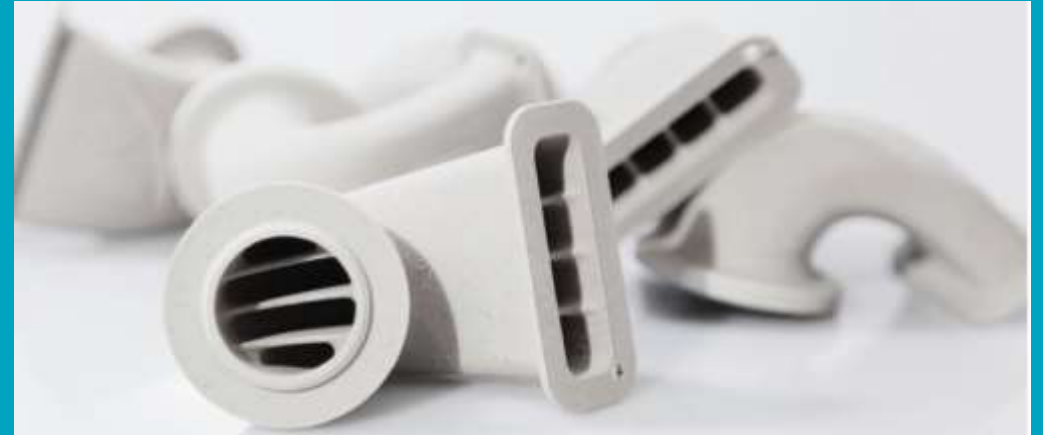
Figura 7: Tubos de ventilación fabricados con SLS que incluyen partes internas críticas para su diseño que no se podrían ejecutar tan fácilmente con medios convencionales. [4]
