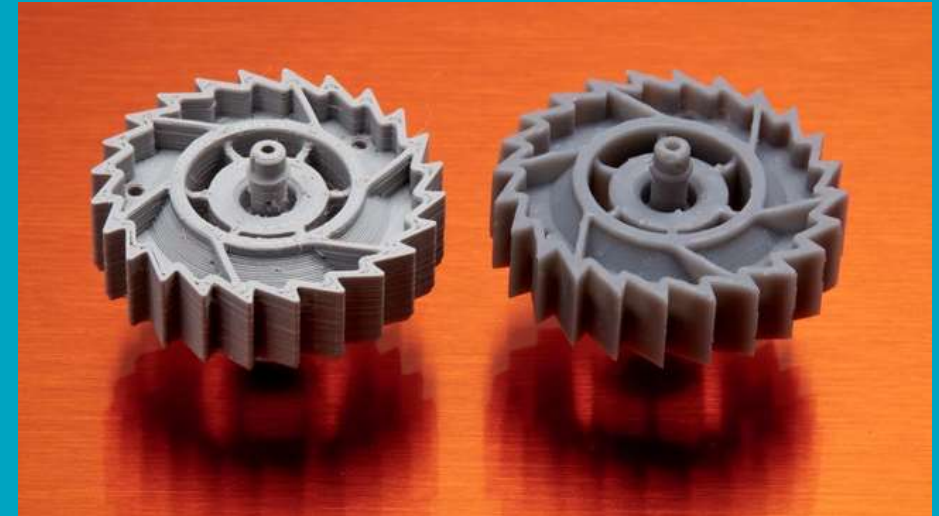
Figura 9: MDF (izquierda) vs SLA (derecha) [1]
