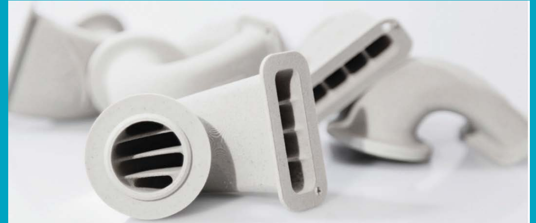
Slika 7: Zračni kanali, zgrajeni s sistemom SLS, ki vključujejo notranje značilnosti, ki so ključne za obliko in jih ni mogoče enostavno izvesti z običajnimi sredstvi. [4]
