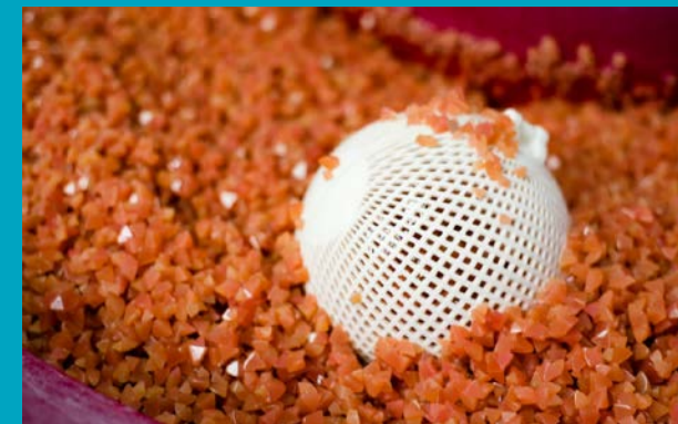
Slika 8: SLS kos, ki je sušen/vibro loščen. [4]
