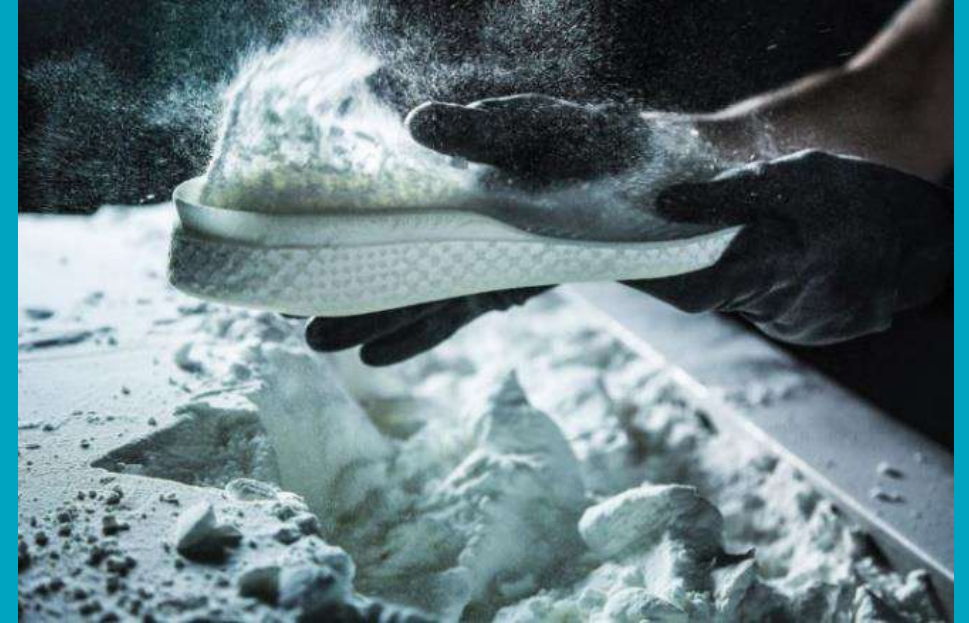
Figura 5: Silueta de un zapato creado con SLS [5]
